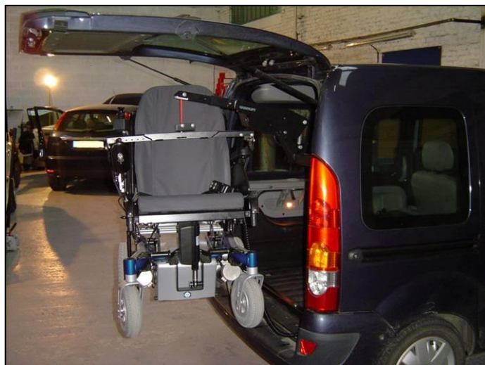
Grue de coffre
