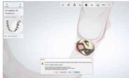
10. Le puits de vissage trop linguale entraîne une fragilité de la future couronne.
