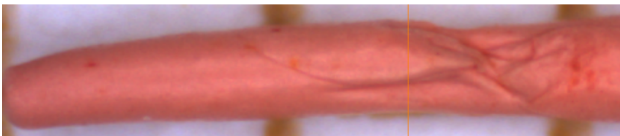
Figure 33 : Image au Sol161® d'un cône vu de profil présentant des déformations importantes.
