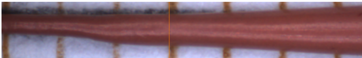
Figure 29 : Image au Sol161® d'un cône vu de profil présentant des défauts de conicité.
