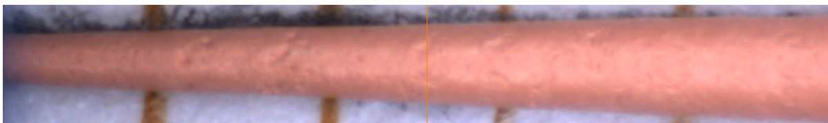
Figure 28 : Image au Sol161® d'un cône vu de profil présentant des rugosités de surface :
